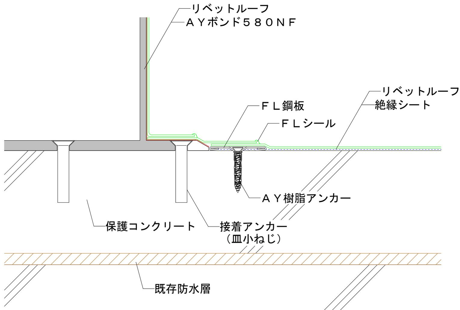
※保護コンクリートが薄い場合は、内アンカータイプを検討してください。
