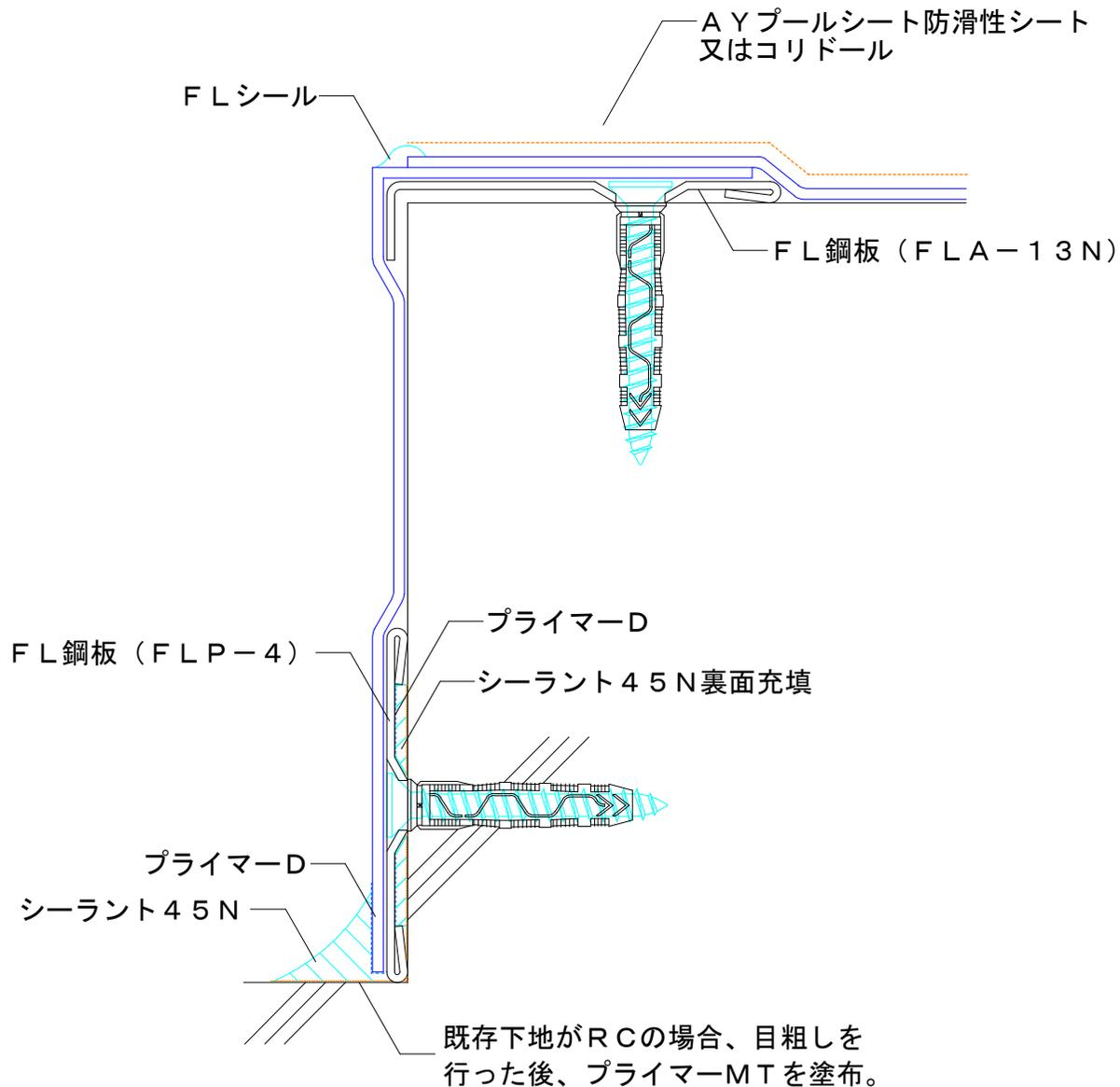
※FL鋼板等の裏面充填材としてボンドエフレックスを用いる事も可能です。
