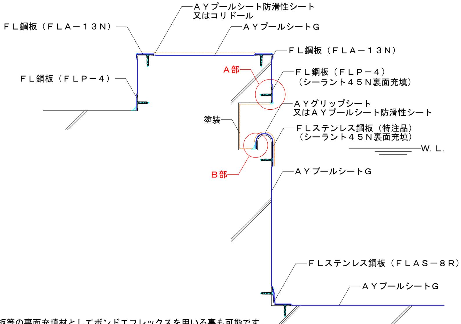
※FL鋼板等の裏面充填材としてボンドエフレックスを用いる事も可能です。
