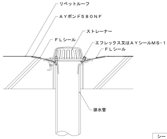
●防水性能の向上のため、顎の広いドレンの採用を推奨します。 (カネソウ社製WHP、第一機材社製RVWPC-Kなど)
